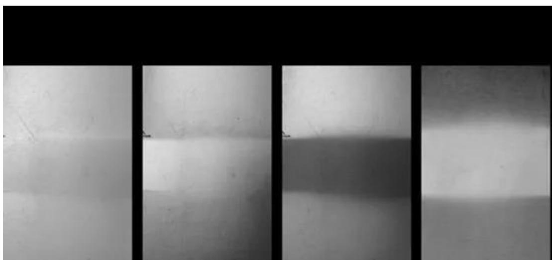
图 11：从左到右，依次是从平行偏振到正交偏振，偏振角的变化突出了坡度的变化，照明角度没有变化
