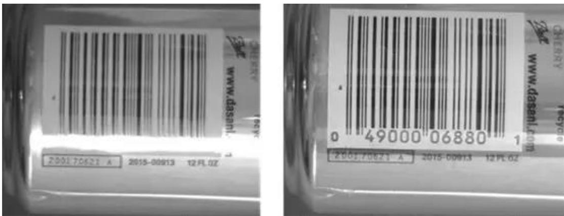
图 3：圆罐子上的条码图像。左侧图像中，条码下的打印号码不可读；右侧图像中，使用正交偏振镜后，打印号码清晰可见
