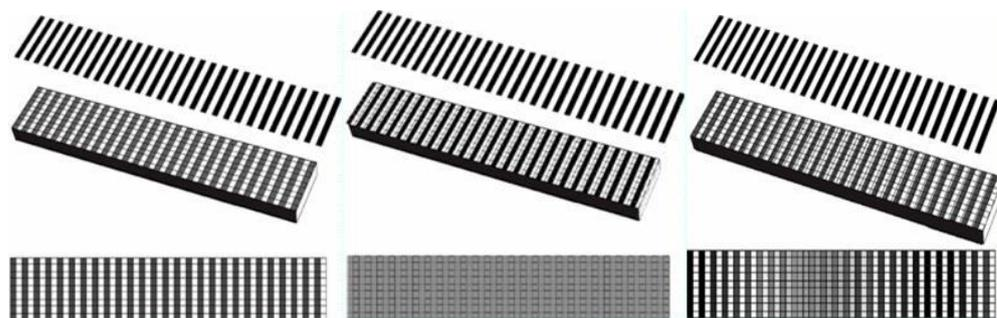
正由於 CCD 分布是如此的规律，所以你可以了解如果是拍摄一组同样条理分明的密集线条，例如：上图中的黑白相间的 Bars，如果 Bars 的密度低於 CCD 间格的密度，当然拍出的影像是『条条皆清楚』（左图）；反过来说，如果 Bar 的密度远高於 CCD 的间格，那么数位相机就会将其换算成一整片的『灰』色（图中）。可是如果 Bar 的密度恰好介於 CCD
