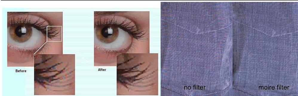
『伪色』的形成除了 摩尔效应之外，感光器的三原色 RGB 色块排列也要付很大一部分责任。这是因为在颜色取样的同时，因为空间差而没有取样到的颜色，数位相机中的影响处理引擎仍会按照 CCD 色块的顺序排列 (RGB)，试图为每一个画素去分配应有的颜色。这种情况在大量色块均匀分布时是正确的处理程序。可是遇到突出部或微细构造时，这样的颜色换算往往会出现错误而产生伪色。
